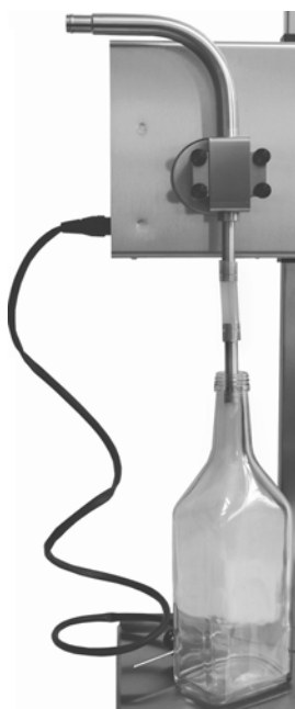
C: горлышко-Ø 20 mm: форсунка- Ø 10 mm
