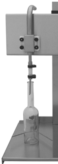
C: горлышко-Ø 20 mm: форсунка- Ø 10 mm
