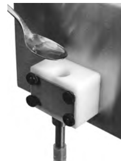
Рис. 4.3 а Наполнение насосной головки
