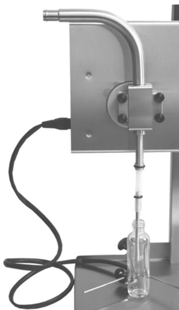
D: горлышко-Ø > 20 mm: форсунка- Ø 15 mm
