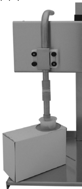
D: горлышко-Ø > 20 mm: форсунка- Ø 15 mm
