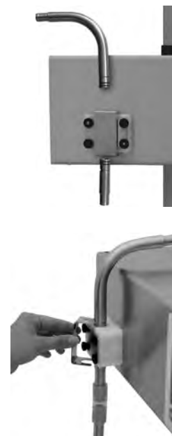
Рис. 4.3 б Монтаж трубного колена
